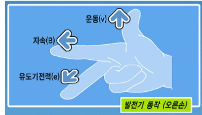
$$\vec{F} = I \vec{L} \times \vec{B} \qquad e = \vec{v} \times \vec{L} \times \vec{B}$$
